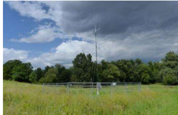
Abbildung 15: Messsystem in Ingelheim zur Ermittlung von innerstädtischen Hitzehotspots und Kaltluftentstehungsgebieten (Quelle: Zentrum KlimaAnpassung, https://zentrum-klimaanpassung.de/ , Berlin 2023)
