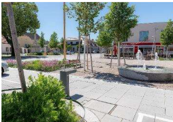
Abbildung 75: Platzgestaltung mit Tiefbeeten und Brunnen (Quelle: Garten + Landschaft, Schwammstadt Lanzenkirchen)
